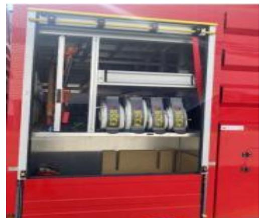
箱 门：高强度铝合金型材料，箱门关闭后密封、防水，箱门关闭时自动锁闭，在三级道路以60Km/h行驶时器材箱门不会自动开启，所有帘子门可以用一把钥匙开启。卷帘门及内饰板经阳极氧化处理。
