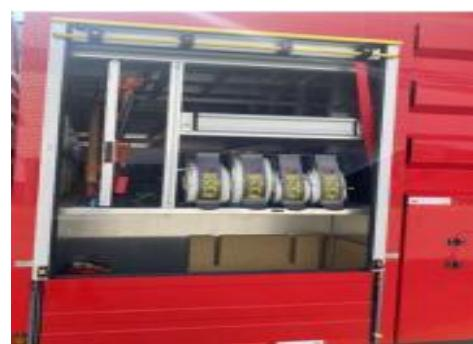
**箱门：**高强度铝合金型材料，箱门关闭后密封、防水，箱门关闭时自动锁闭，在三级道路以60Km/h行驶时器材箱门不会自动开启，所有帘子门可用同一把钥匙开启。卷帘门及内饰板经阳极氧化处理。
