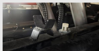
污水箱撑杆感应器 ↑
