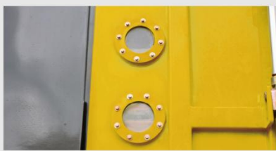
污水箱视污管口 ↑
