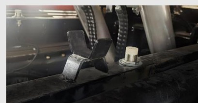
污水箱撑杆感应器 ↑
