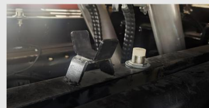
污水箱撑杆感应器 ↑
